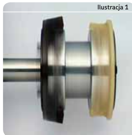
Koszyk poliamidowy ze standardowego łożyska SKF i z łożyska E2 obracają się z prędkością 8000 obr/min. Koszyk z łożyska E2 wykazuje znacznie mniejsze odkształcenie.
