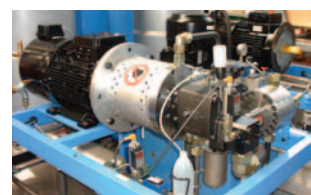
bezobsługowa instalacja pompy dozującej alkohol wielowodorotlenowy oraz izocyjanian w wysokociśnieniowych wtryskarkach PUR
